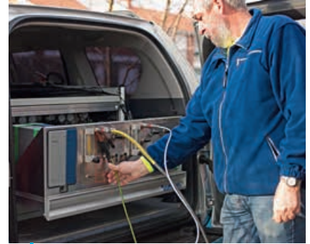
Le degré d'odorisation du gaz naturel distribué est contrôlé dans un véhicule de mesure équipé d'un micro-chromatographe en phase gazeuse.
